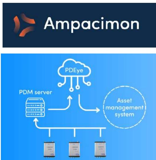
El sistema funciona mediante el uso de **sensores instalados permanentemente** que detectan señales de alta frecuencia generadas por las descargas parciales dentro del sistema de aislamiento.
